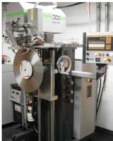
Całkowicie automatyczna maszyna lutująca do pił tarczowych
