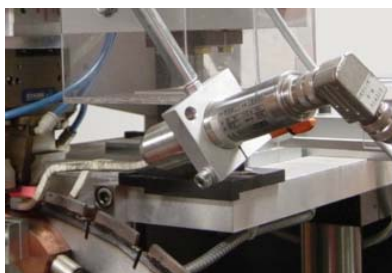
Pirometr mierzy temperaturę pojedynczego segmentu
