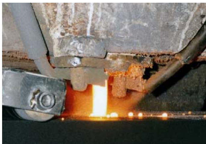
Fotografia 1: Strumień ciekłego metalu w automatycznej linii odlewniczej.
