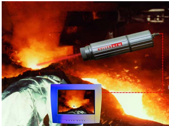
Fotografia 5: Pomiar temperatury z kamerą video w kanale transferowym pieca nadmuchowego
