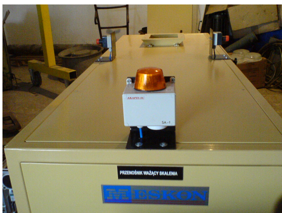
Sygnalizator przedstartowy i przyciski bezpieczeństwa zabudowane na skrzyni przenośnika.
