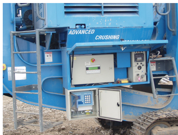
Miernik MMC-05a zainstalowany na maszynie budowlanej pracującej w trudnych warunkach atmosferycznych, przy silnych drganiach i zapyleniu.
